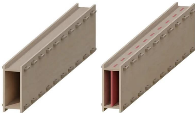
Рис. 3. Варианты сечений сборно-разборных коробчатых балок
