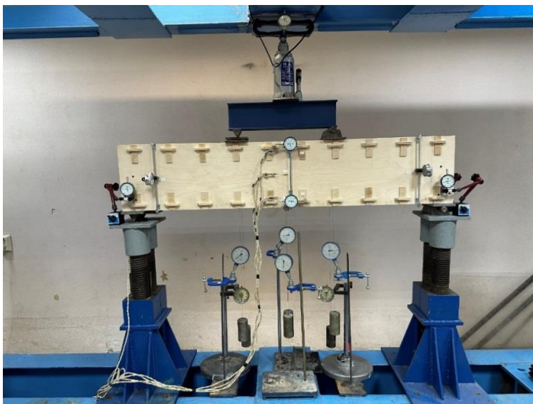
Рис. 4. Испытания балки коробчатого поперечного сечения пролётом 1,5 м
